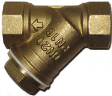
**Рабочие среды и применения:** механическая очистка рабочей среды от грязи, ржавчины, стружки и т. д., в системах отопления, тепло-водоснабжения и системах кондиционирования. Также данную конструкцию можно использовать на воздух, азот, масла, углекислый, природный (натуральный) газ и другие нейтральные жидкости и газы.
