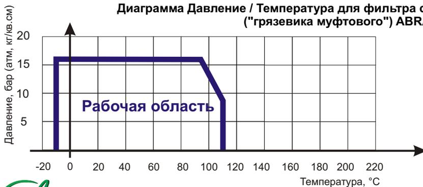
Диаграмма определяет рабочую область для фильтра сетчатого латунного резьбового в координатах Давление (в барах приборного) / Температура (°C).
